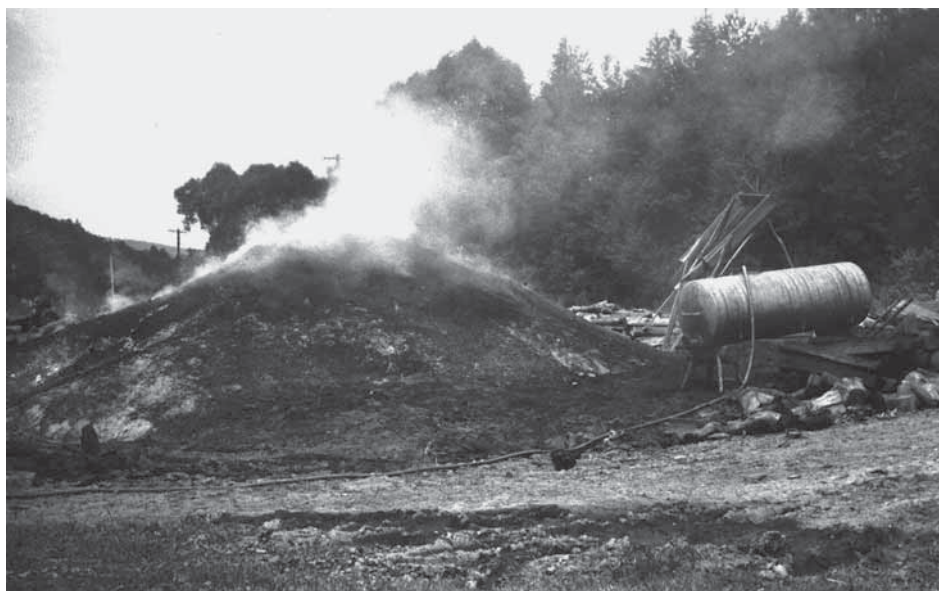
Ryc. 3. Wygaszony mielerz stygnie (Archiwum RDLP w Krośnie) Fig. 3. Extinguished “mielerz” is cooling down (Archive of RDSF in Krosno)
