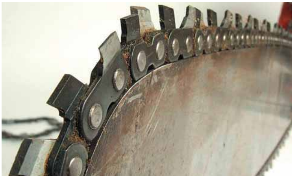
Ryc. 7. Piła łańcuchowa typu scratcher ( www.wikipedia.org )
