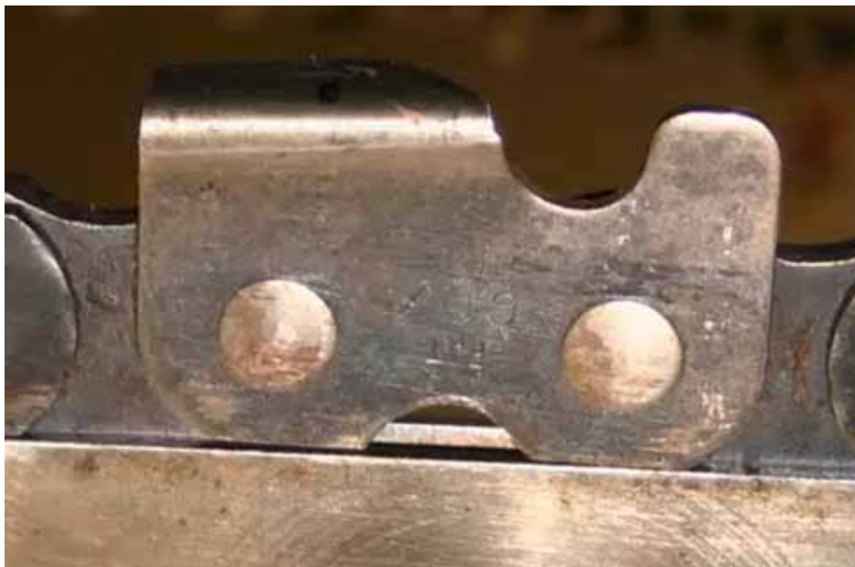
Ryc. 9a. Jedna z pierwszych konstrukcji pił łańcuchowych typu żłobikowego, której wynalazcą i konstruktorem był Joseph Buford Cox ( www.northernwoodlands.org )
