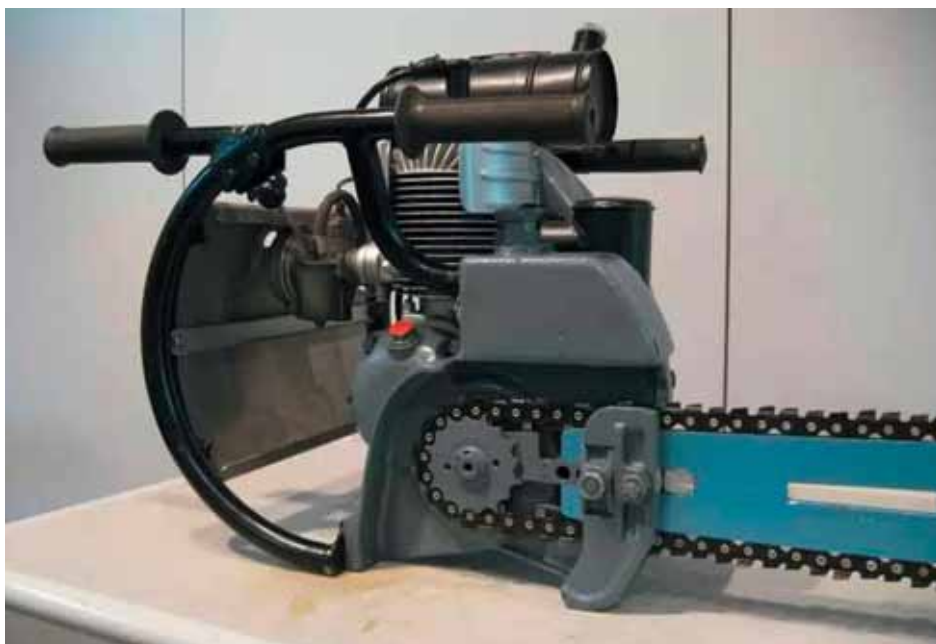
Ryc. 18. Jednoosobowa pilarka Stihl BL (1952) ( www.chainsawcollectors.se )
