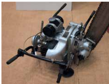
Ryc. 16b. Pierwsza pilarka spalinowa firmy Dolmar wyprodukowana u podnóża góry Dolmar w Turyn- gii ( www.upload.wikimedia.org ) Fig. 16b. The first gasoline powered chain saw, produced by Dolmar at the foot of Do- lmar Mountain in Thuringia ( www.dolmar-powerproducts.com )
