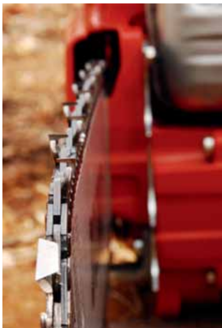
Ryc. 9b. Współczesna konstrukcja pił łańcuchowych typu żłobikowego, której początek dał w 1946 roku Joseph Buford Cox
