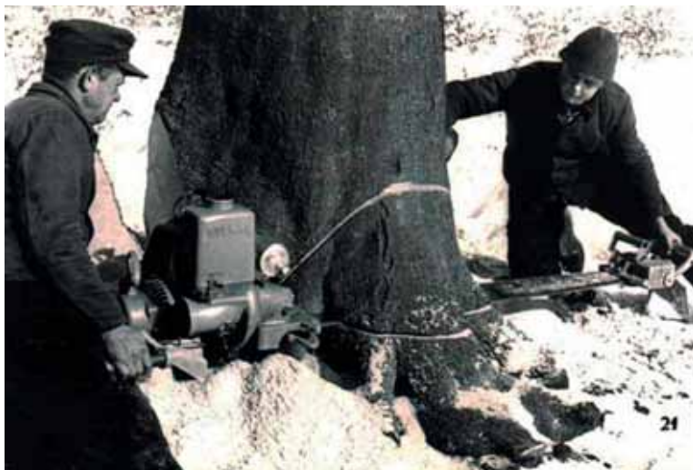
Ryc. 15. Praca pilarką dwuosobową (TOMCZAK I IN. 2002) Fig. 15. Operation of a two-man saw (TOMCZAK ET AL. 2002)
