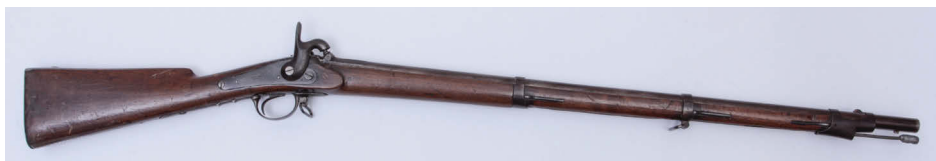
Ryc. 14a. Strzelba kapiszonowa Ignacego Kępki z Adampola, wytwórnia Devisme a Paris, produkcja ok. 1850 roku, kaliber 16 mm, długość całkowita 127 cm. Ze zbiorów MWP Warszawa
